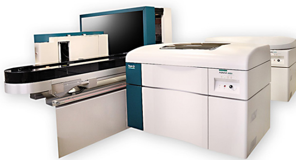
Obr. 7. Automatická robotická linka WorkCell so zabudovanými analyzátormi ADVIA 1650, ADVIA CENTAUR a podávačom vzoriek
