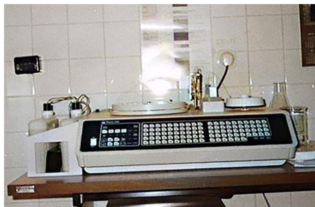
Obr. 6. Poloautomatický analyzátor ENCORE II – pipetovacia časť
